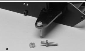
STEP 4 INSTALL THE LONGER BODY POSTS WITH 3/8 SCREWS ON EACH SIDE OF THE FRONT AXLE PLATE. YOU CAN ADD THE BODY POST NUTS LATER TO SET THE BODY HEIGHT.
