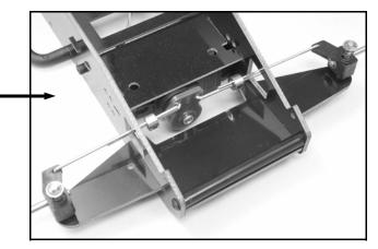
*STEP 12* INSTALL THE 5188 RIDE HEIGHT ADAPTORS FROM BAG L2 AND ADD THE 5452 REAR BUSHINGS.
