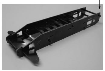
**STEP 1 OPEN BAG J1**. ATTACH SIX CHASSIS SPAC-ERS TO EITHER CHASSIS SIDE . USE 1/2" BUTTON HEAD SCREWS WITH 2434 MOUNTS ON THEM ON THE TOP REAR AND 2ND FROM THE FRONT. USE 3/8 LONG BUTTON HEAD SCREWS ON THE BOTTOM REAR AND FRONT SPACERS. USE 3/8 CAP SCREWS ON THE TWO <u>R</u>EMAINING TWO SPACERS.
